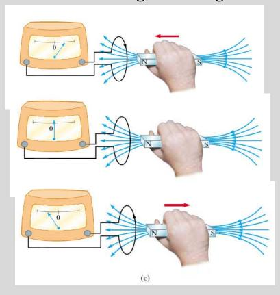
Es importante notar que no es necesaria la existencia de una batería para producir una corriente en la espira, por lo que se dice que tenemos una *corriente inducida* en la espira como producto de la presencia de un flujo magnético
