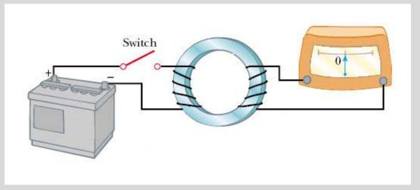
De nuevo, en la espira secundaria NO hay conectada una batería para producir una corriente en la espira, por lo que se dice que tenemos una *corriente inducida* en la espira como producto de la presencia de un flujo magnético, en este caso, producido por la corriente en la espira primaria.
