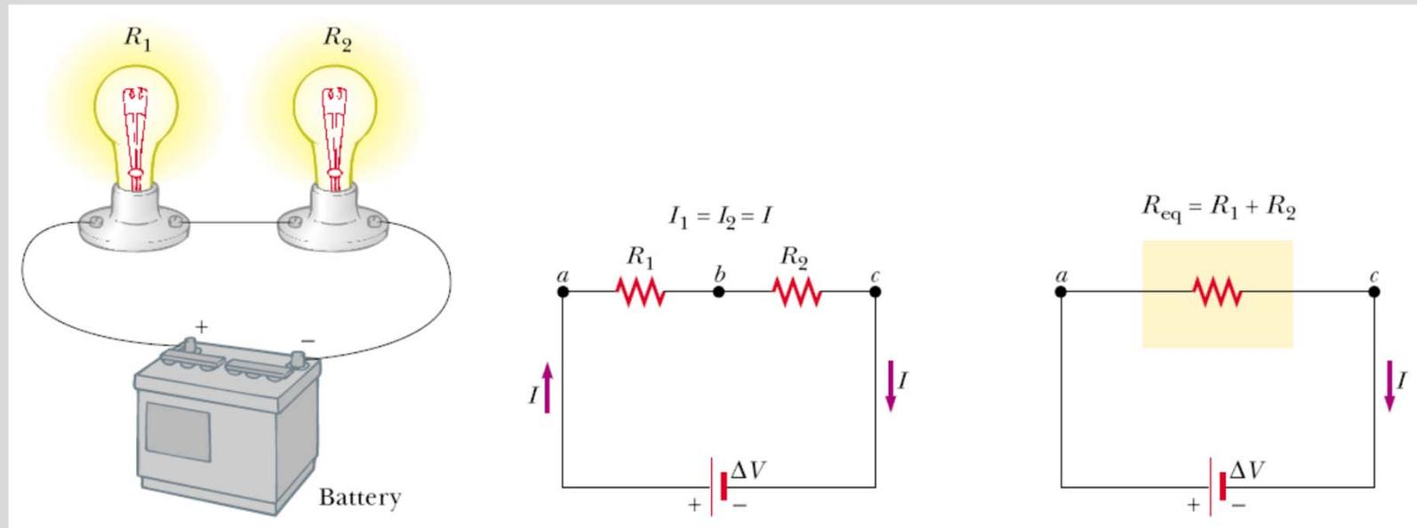
En este tipo de conexión la corriente eléctrica a través de todas las resistencias es la misma, por lo que al aplicar la Ley de Ohm se encuentra que la resistencia equivalente está dada por
