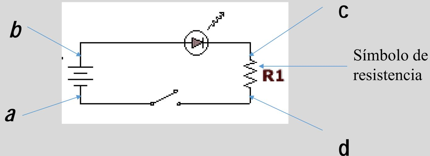
Conforme la carga  $Q$  se mueve desde  $a$  a  $b$  a través de la batería, su energía potencial eléctrica aumenta en una cantidad  $QV$ , mientras que la energía potencial química en la batería disminuye por la misma cantidad.
