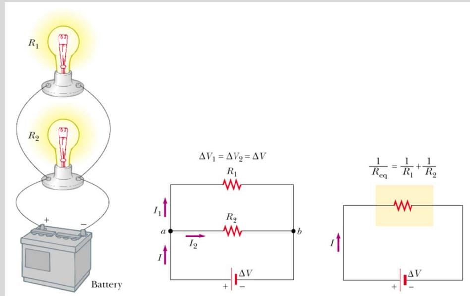
En este tipo de conexión la diferencia de potencial es la misma para todas las resistencias, mientras que la corriente a través de la batería es la suma de las corrientes de cada resistencia. De nuevo, al aplicar la Ley de Ohm se encuentra que la resistencia equivalente está dada por
