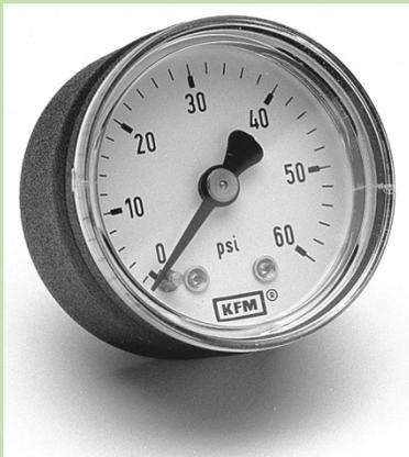
Esta diferencia de presión  $p$  existente en el fluido y la presión atmosférica  $p_{atm}$  se conoce como **presión manométrica** ( $p_{man}$ ).
